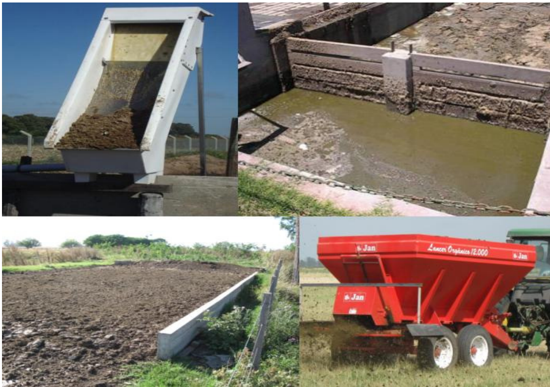
Figura 3.13 Separación de sólidos, almacenamiento y aplicación de estiércol utilizados en la Argentina. Imágenes tomadas durante la realización de las encuestas.
