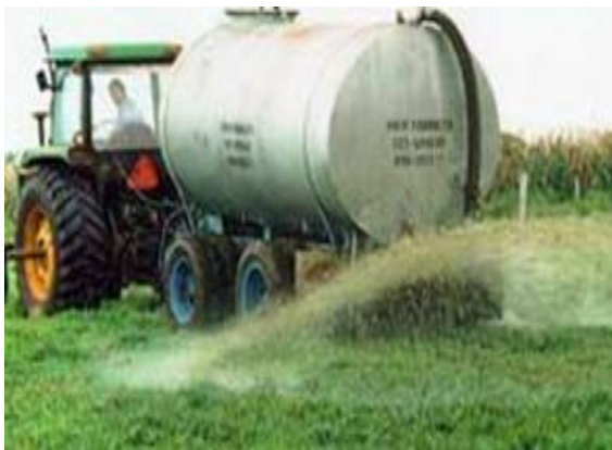
Figura 3.11 Equipamiento de baja tecnificación generalmente utilizado en las cuencas lecheras para distribución de efluentes como fertilizantes.
