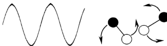
Figura 3.15 Mecanismo de polarización dipolar
