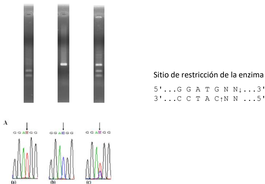
Figura 10: Patrones de restricción obtenidos con BseGI . (a) gen aac(6′)-Ib digerido con la enzima, el electroferograma muestra el sitio de corte la enzima de restricción. (b) gen aac(6′)-Ib-cr presenta cambios de nucleótido el sitio de corte de la enzima (T304C/A y G535C), evitando el reconocimiento por parte de la enzima. (c) patrón obtenido en un aislamiento con duplicaciones génicas que presenta aac(6′)-Ib como la variante modificadora de fluoroquinolonas con su respectivo electroferograma.
