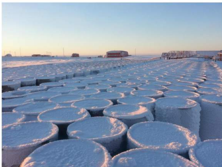
Figura 1.6. Tambores de 200 l conteniendo GOA, nafta y JP1 en Base Marambio, expuestos a -50 °C.
