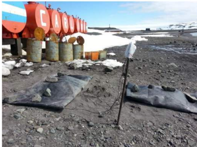
Figura 4.4. Disposición final de las biopilas en su conformación cerrada con la inclusión de los sensores del datalogger.
