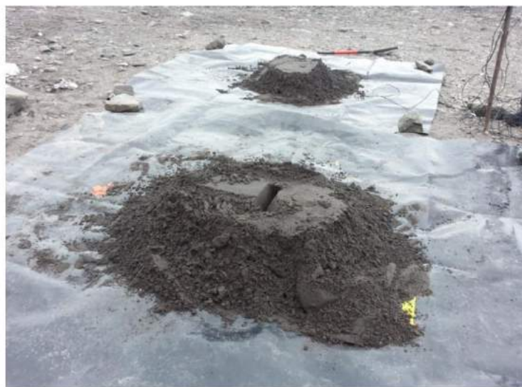
Figura 4.2. Disposición del suelo sobre la geomembrana e incorporación de los sensores en el núcleo de la biopila.
