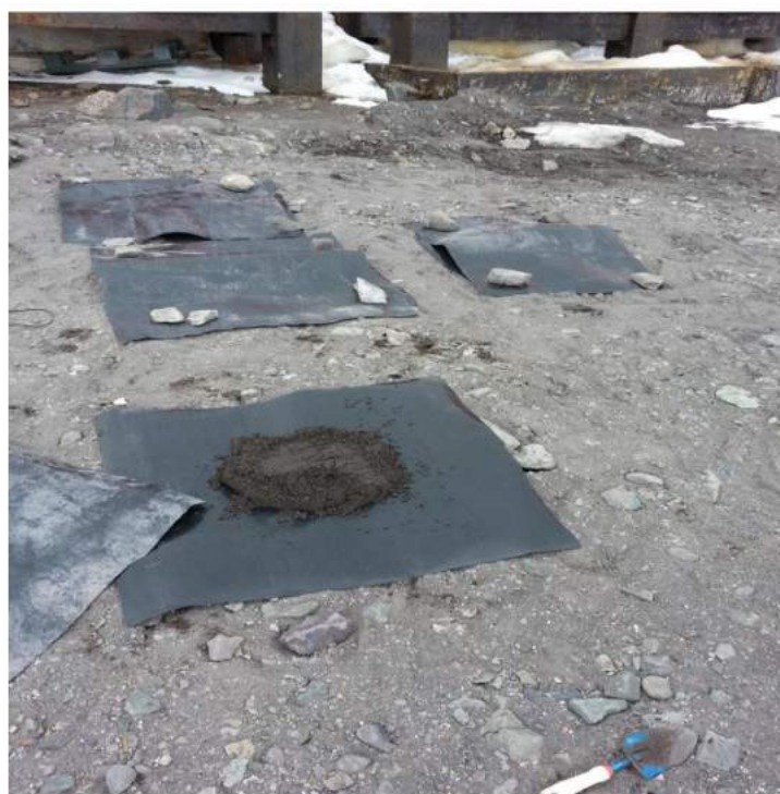
Figura 5.1. Disposición de los ensayos en mesocosmos, conteniendo 10 kg de suelo por sistema.
