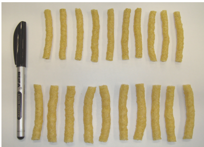
Figura 58: Productos obtenidos por extrusión. Hilera superior: fragmentos correspondientes al nivel de humedad inicial de M2 (18 %). Hilera inferior: fragmentos correspondientes al nivel de humedad inicial de M1 (16 %).
