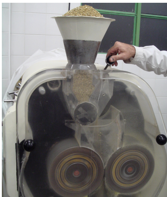
Figura 14: Proceso de molienda de los frutos en molino de rolos estriados.
