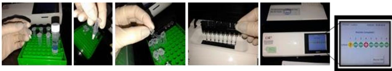
Figura 4.7: Secuencia de pasos para el ensayo de iiPCR mediante el uso del dispositivo POCKIT™.
