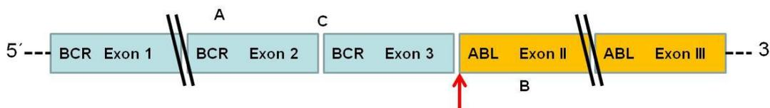
**Figura M&M-I 22** Estructura del ARN mensajero y localización de los oligonucleótidos, para diagnóstico. A y B representan los cebadores utilizados para dos secuencias de unión conocidas para BCR-ABL1 en LMC y C es un cebador específico para el exón 3 en el gen BCR y para el exón II en el ABL ( b3a2 ), la flecha indica la unión entre BCR y ABL (Kawasaki, 1988)
