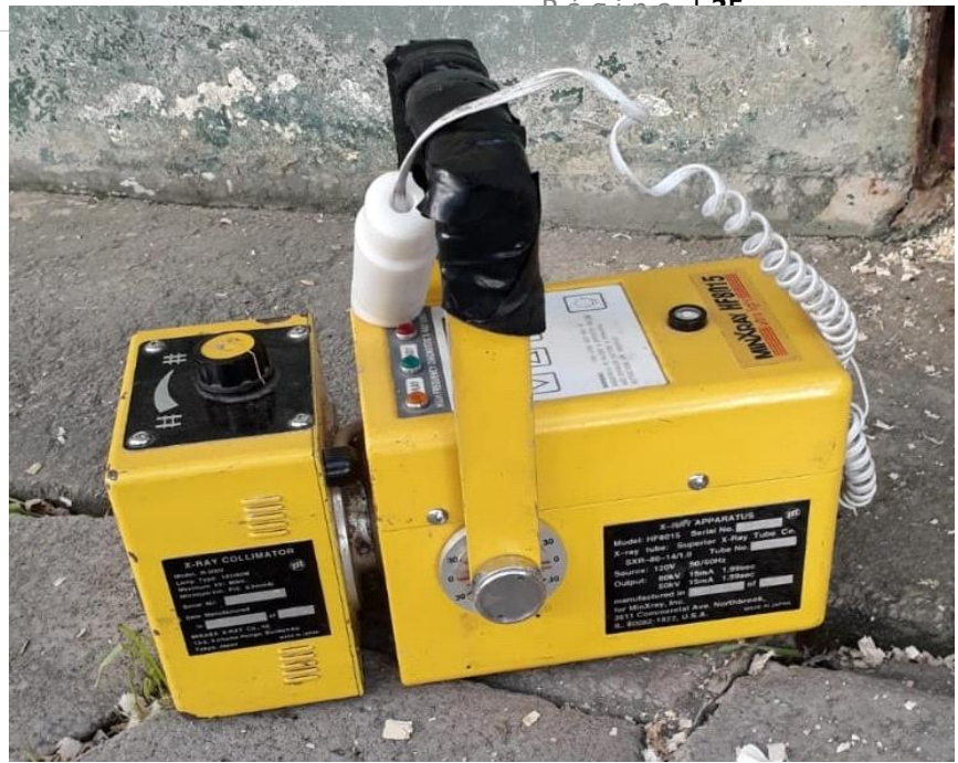
Figura 19: equipo digital de radiografía (imagen propia).
