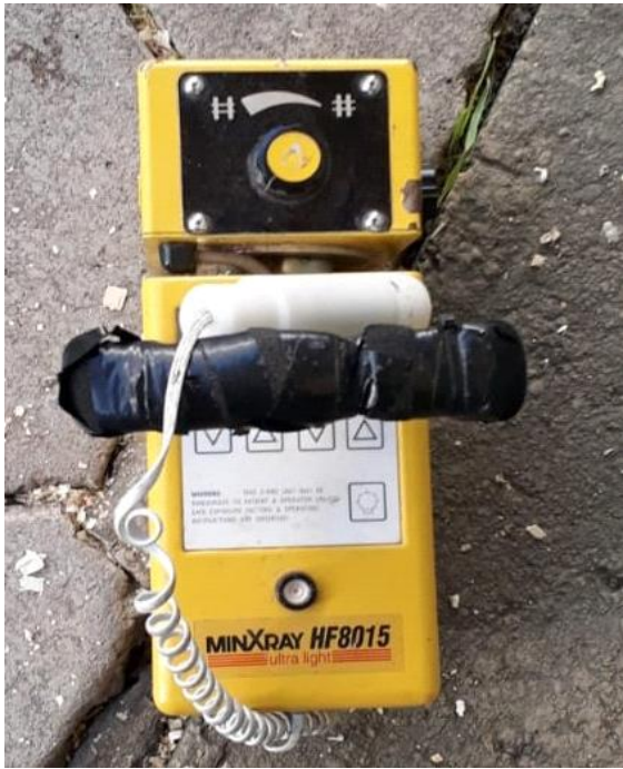
Figura 19: equipo digital de radiografía (imagen propia).
